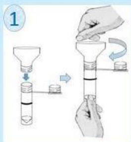
步骤1: 拧开小管盖, 如图组装小管与漏斗。
