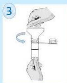
步骤3: 拧下漏斗, 拧紧小管盖, 确保不漏。
